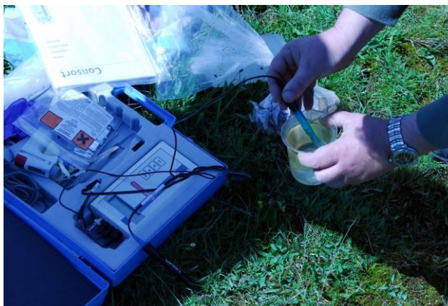
Εικόνα Ι.1 Επιτόπια μέτρηση φυσικών παραμέτρων (eh, Rh, T), (λίμνιο Αλύκαινας, Οίτη).
