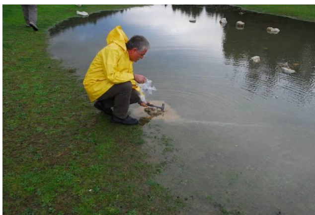
Εικόνα Ι.3. Δειγματοληψία ιλύος πυθμένα στο λίμνιο Λούκα, Οίτη
