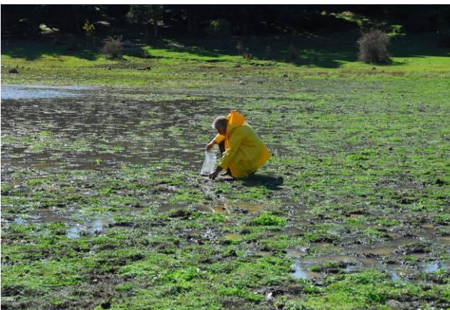
Εικόνα 1.11. Δειγματοληψία ιλύος πυθμένα στο λίμνιο Νευρόπολης, Καλλίδρομο.
